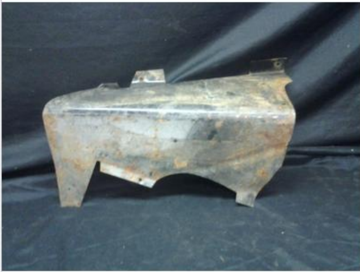
Plåten som täcker bensinröret i bakluckan
